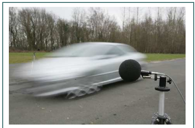
Mesure de bruit de passage sur piste normalisée
