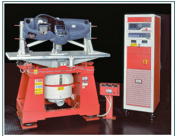
Banc d'essai de bruits parasites sur tableau de bord
